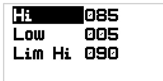
Рисунок 3.10 – Установка предельных значений по температуре
