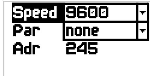
Рисунок 3.14 – Настройки протокола связи по протоколу RS-485
