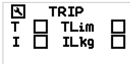
Рисунок 3.4 – Флаги защитного отключения
